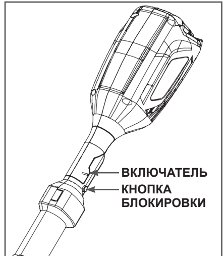
Рис. 9 Расположение органов управления на задней рукоятке
