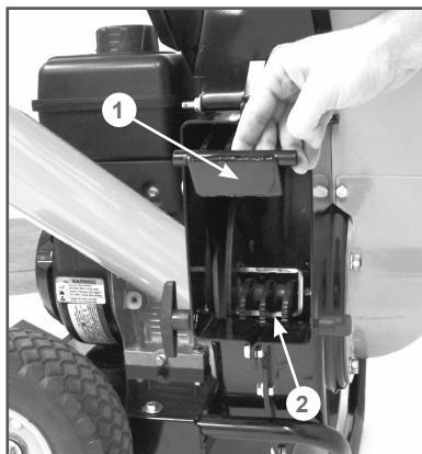
Рис. 19 Поворот решетки разгрузочной трубы вверх
