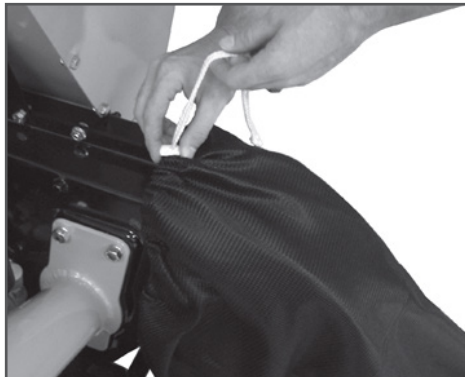
Рис. 4 Установка мешка для сбора продуктов измельчения
