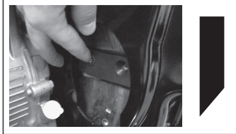
Рис. 23 Установка ножа измельчителя
